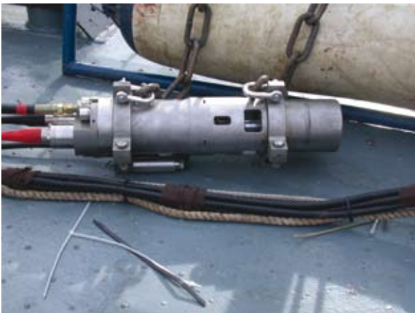
Abb. 4.4 Als Energiequelle wurde ein airgun (30 ci Mini GI) eingesetzt.
