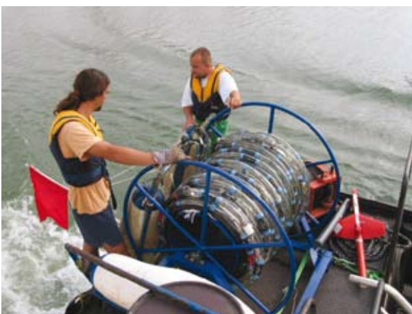
Abb. 4.5 Kabeltrommel mit Hydrophonkabel. Daneben liegt ein Flügel zur permanenten Fixierung des Hydrophonkabels in einer Wassertiefe von 1 m.
