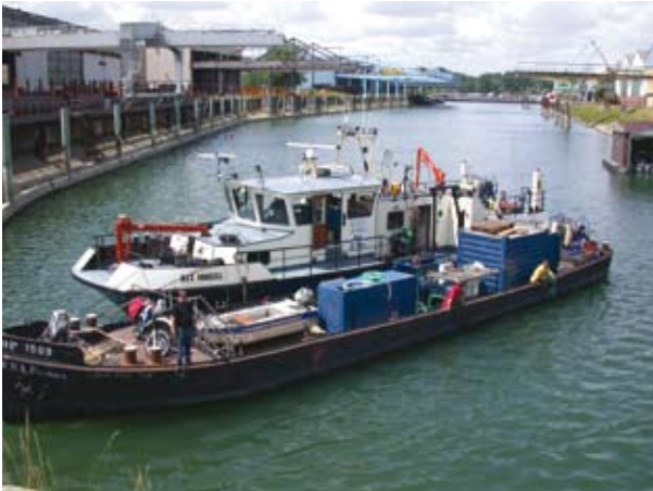
Abb. 4.3 Das Messboot „Max Honsell“ (hinten) der Landesanstalt für Umwelt, Messungen und Naturschutz Baden-Württemberg (LUBW) mit dem seitlich befestigten Beiboot (Prahm des Wasser- und Schifffahrtsamtes Freiburg).
